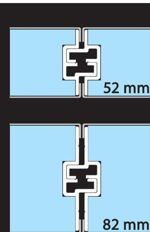
El panel autoportante fabricado por Camidix S.L. presenta un sistema de unión que garantiza un buen ajuste y drenaje dándole mayor resistencia y robustez al panel.
